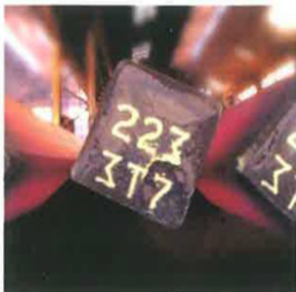
鋼片マーキング例 / Example of marking
